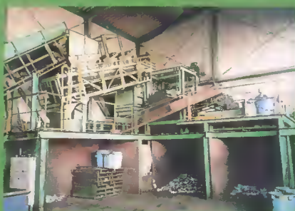
Máquina de separación automática Las latas de acero y de aluminio se separan mediante fuerza magnética.
